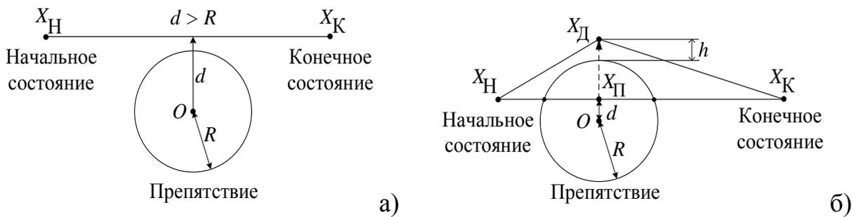
Рисунок 3 – Перемещение точки из начального состояния в конечное в рабочей зоне с препятствием: а) прямое движение возможно; б) прямое движение невозможно
