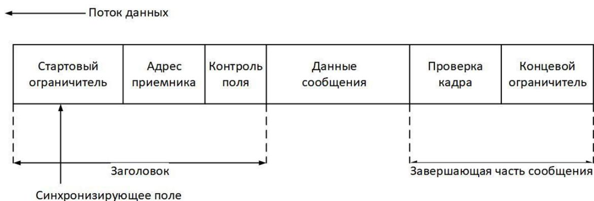
Рисунок 2. Синхронная передача данных.
