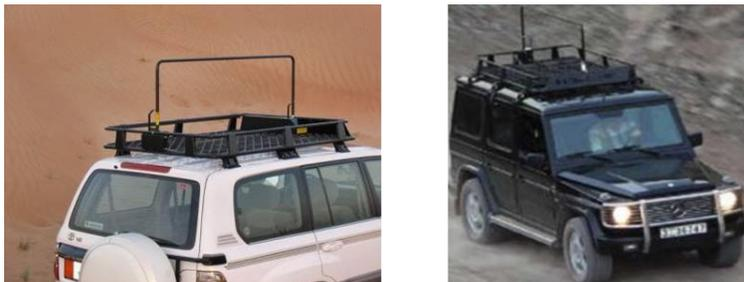
Рисунок 9. Антенные устройства типа «АЗИ» (NVIS).
