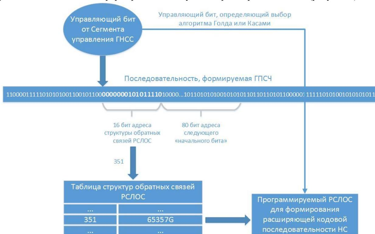
Рисунок 1. Схема выбора структуры обратных связей РСЛОС для формирования расширяющих кодовых последовательностей
