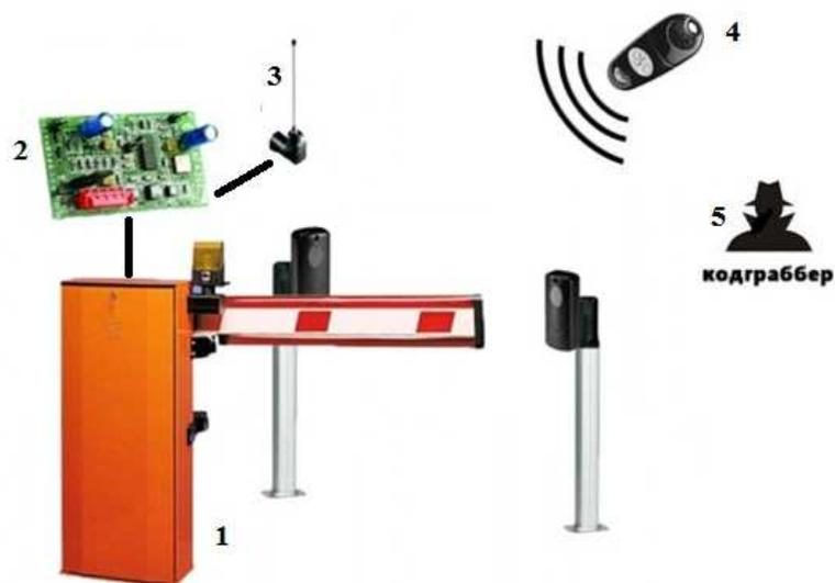
Рисунок 1. 1 – шлагбаум; 2 - плата управления электронного замка шлагбаума; 3 – антенна, принимающая сигнал от брелока; 4 – брелок, открывающий или закрывающий шлагбаум; 5 – кодграббер, предназначенный для перехвата передаваемого сигнала от брелока.
