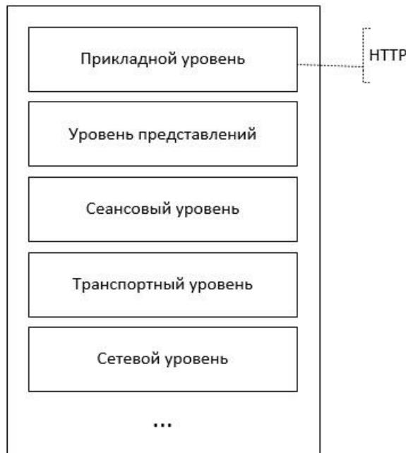
Рисунок 1. Протокол HTTP в сетевой модели OSI
