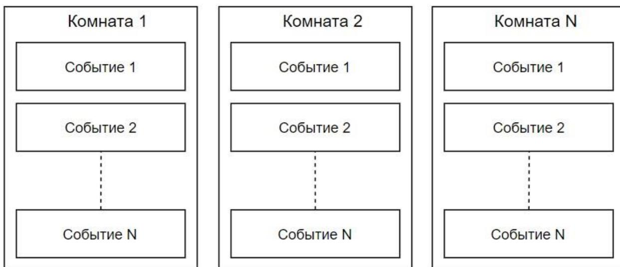
Рисунок 2. Логическая структура комнат в протоколе Matrix
