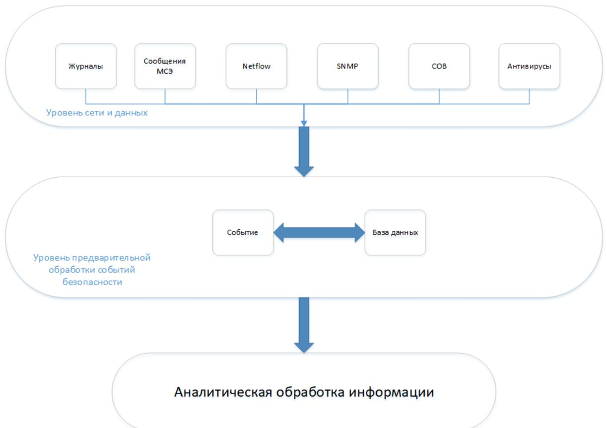
Рисунок 1. Типовая архитектура SIEM системы
