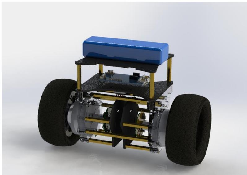
Рисунок 12. Рендеринг мобильного двухколесного балансирующего робота.
